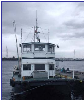
RTK-GPS システム搭載深淺測量船
