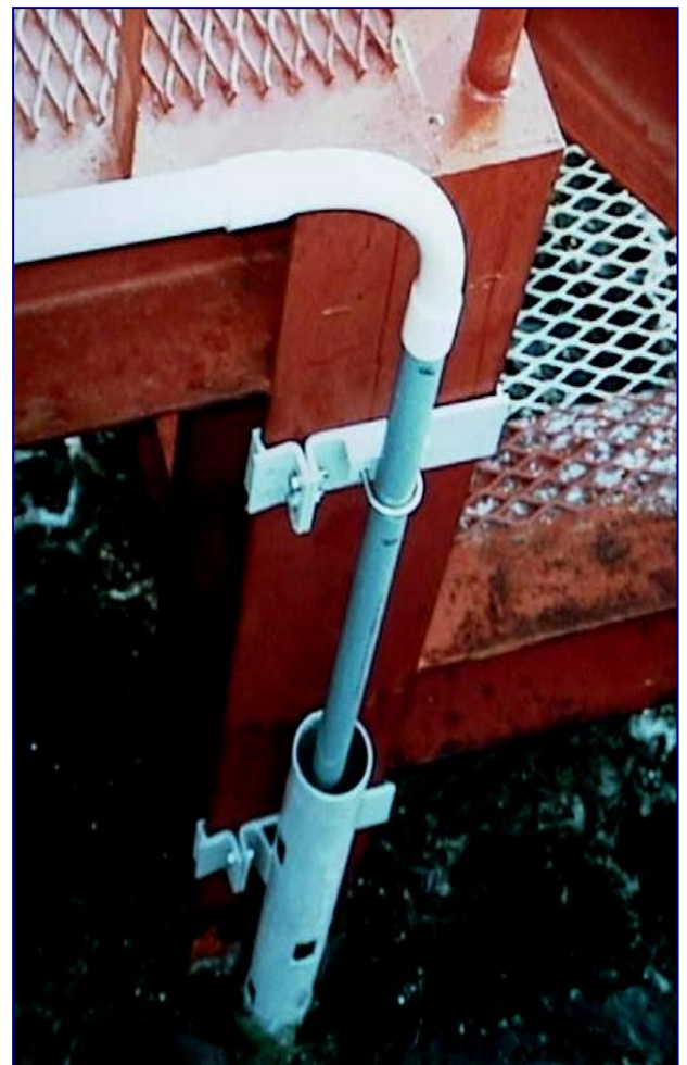
保護パイプを用いた潮位センサーの設置例
